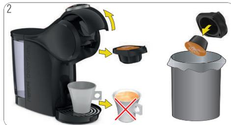
2 No beba el café. Abra la manija de bloqueo. La máquina libera presión. Retire el soporte de la cápsula. Ponga la cápsula usada en la basura.
