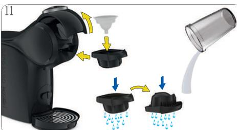
Retire el recipiente. Vacíe y limpie el recipiente. Extraiga el soporte de la cápsula. Retire la herramienta de enjuague. Guárdelo en un lugar seguro para su posterior limpieza o descalcificación. Enjuague ambos lados del soporte de la cápsula con agua potable fresca. Vuelva a insertar el porta cápsulas.
