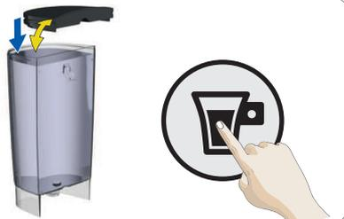
Compruebe si el depósito de agua contiene suficiente agua potable fresca. Si no es así, rellene con agua potable fresca y pulse el botón de inicio/parada para continuar la preparación. En caso de que siga sin salir líquido, consulte el punto 10.3 “NO SALE LÍQUIDO – ¿CÁPSULA BLOQUEADA?”.
