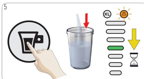
5 Pulse el botón de inicio/parada. Se inicia la descalcificación de la máquina. El display de barras de volumen se mueve desde el nivel superior hasta el 4º nivel. La máquina se descalcifica con agua caliente en funcionamiento de inicio-parada. La máquina detiene la descalcificación una vez que el depósito de agua está vacío.
