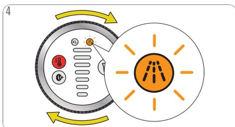
4 Para entrar en el modo de descalcificación, seleccione XL y gire el anillo de control cuatro veces en el sentido de las manecillas del reloj hasta que el LED de descalcificación comience a parpadear.
