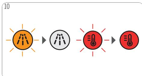
El indicador de descalcificación se apaga, la selección de temperatura parpadea y se ilumina en color rojo continuo una vez que la máquina está lista para su uso.
