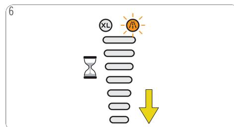
6 Para permitir una mejor eficacia de descalcificación, la máquina se mantiene en espera durante aproximadamente 2 minutos. El display de barras de volumen se mueve hacia abajo hasta que desaparece.
