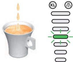
La preparación de bebida se detiene parcialmente durante la preparación o no llega a iniciarse. El display de nivel parpadea en el nivel actual. No sale líquido: Es posible que el depósito de agua esté vacío.
