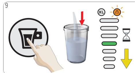
Pulse el botón de inicio/parada. La máquina se enjuaga continuamente con agua caliente. El display de barras de volumen se mueve hacia abajo hasta que desaparece. La máquina detiene el enjuague una vez que el depósito de agua está vacío.
