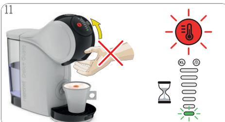
Después de terminar la preparación, el botón de selección de temperatura y la luz del display de volumen parpadean durante un máximo de 8 segundos. **¡No abra la manija de bloqueo durante este intervalo!**
