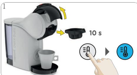
1 Abra la manija de bloqueo. La máquina se enciende automáticamente. Pulse el botón de selección de temperatura en los 10 segundos posteriores al inicio de la máquina para cambiar al modo frío (azul). La bebida fría puede prepararse inmediatamente.
