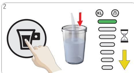
2 Para acelerar el enfriamiento, seleccione el nivel 7 en el display de volumen. Pulse el botón de inicio/parada. Se inicia la descalcificación de la máquina. El display de barras de volumen se mueve hacia abajo hasta que desaparece.
