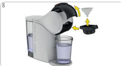
8 Abra la manija de bloqueo. Extraiga el soporte de la cápsula. Retire la herramienta de enjuague. Vuelva a insertar el porta cápsulas.
