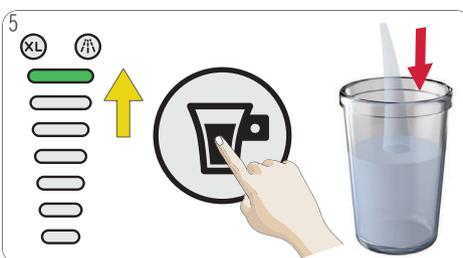
Utilice el anillo de control y seleccione el nivel 7 en el display de volumen (barra superior). Pulse el botón de inicio/parada. Se inicia la descalcificación de la máquina.
