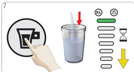
7 Pulse el botón de inicio/parada. Se inicia la descalcificación de la máquina. Espere hasta que la máquina se detenga automáticamente. El botón de temperatura y la luz del volumen parpadean durante un máximo de 8 segundos.
