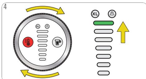
4 Utilice el anillo de control y seleccione el nivel 7 en el display de volumen (barra superior).
