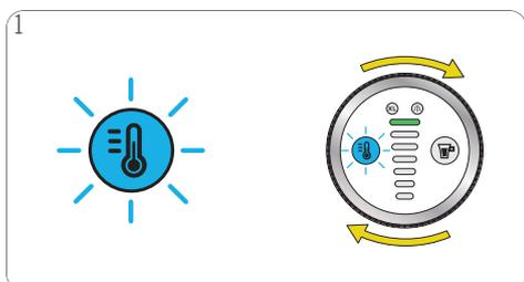
**Opción C:** Se ha preparado una bebida caliente o no se ha seleccionado el modo frío en los 10 segundos posteriores al inicio de la máquina. Pulse el botón de selección de temperatura para pasar al modo frío. El botón de selección de temperatura parpadeará en azul para indicar que la máquina necesita enfriarse.
