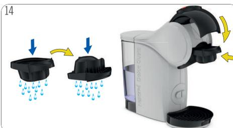
Enjuague ambos lados del soporte de la cápsula con agua potable fresca. Seque el soporte de la cápsula. Insértelo de nuevo en la máquina. Disfrute de su bebida.
