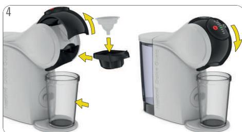
Abra la manija de bloqueo. Ponga la herramienta de enjuague dentro del soporte de la cápsula. Inserte el porta cápsulas en la máquina. Cierre la manija de bloqueo. Retire la bandeja de goteo. Coloque un recipiente grande vacío debajo de la salida de café.
