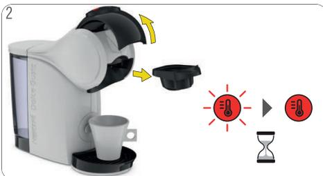
Abra la manija de bloqueo. La máquina se enciende automáticamente. El botón de selección de temperatura parpadea mientras la máquina se calienta durante aproximadamente 40 segundos. Después, el botón de selección de temperatura se ilumina en rojo continuo. La máquina está lista para utilizarse.
