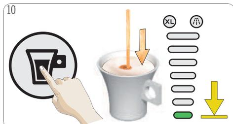
Pulse el botón de inicio/parada. Se inicia la preparación de bebida. **No abra la manija de bloqueo durante la extracción.** Espere hasta que la extracción finalice. La máquina detiene la preparación automáticamente. La extracción puede detenerse manualmente en cualquier momento pulsando el botón de inicio/parada.
