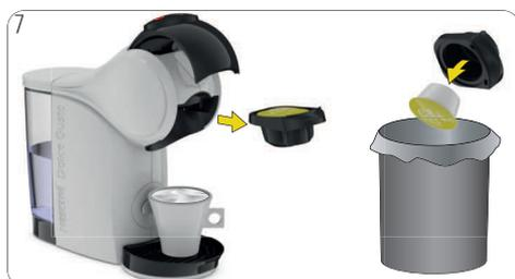
Abra la manija de bloqueo. Extraiga el soporte de la cápsula. Retire la cápsula usada. Ponga la cápsula usada en la basura.
